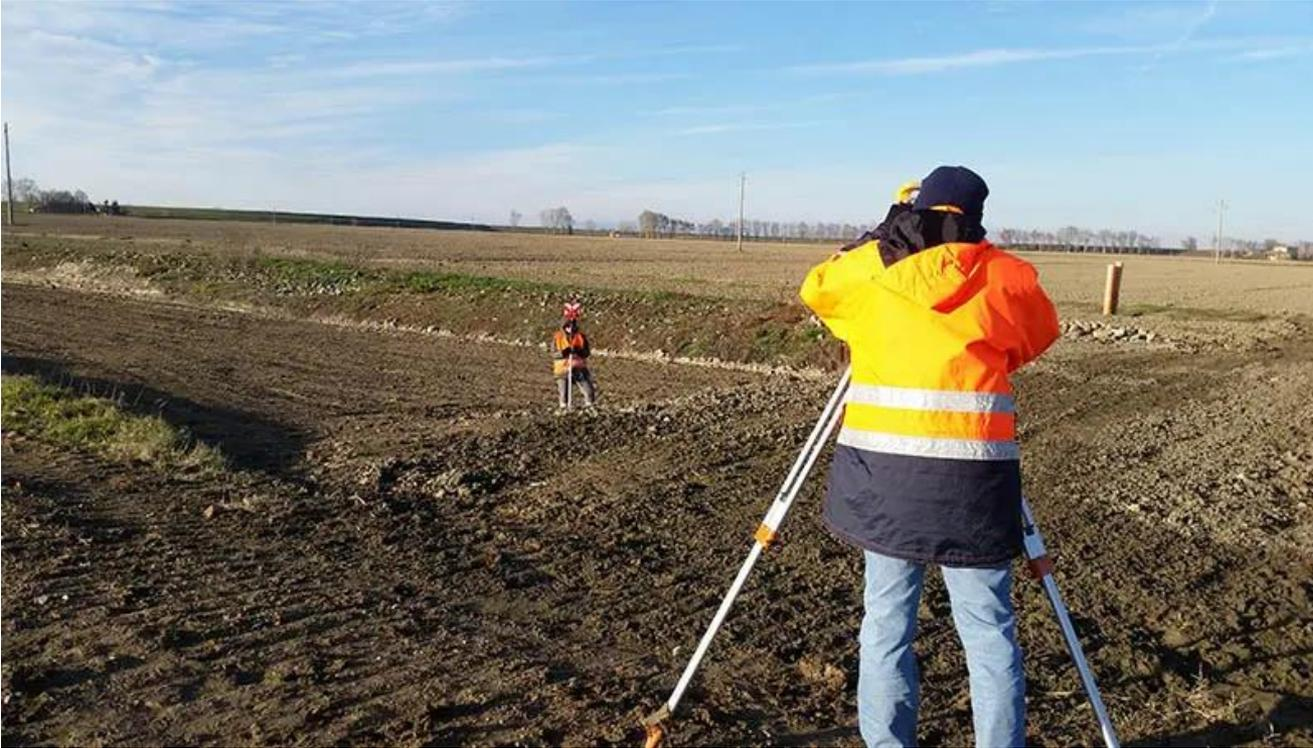
Si definisce rilievo topografico, l'insieme delle operazioni di misura e dei procedimenti che è necessario effettuare al fine di **rappresentare graficamente di una porzione di superficie terrestre.**
