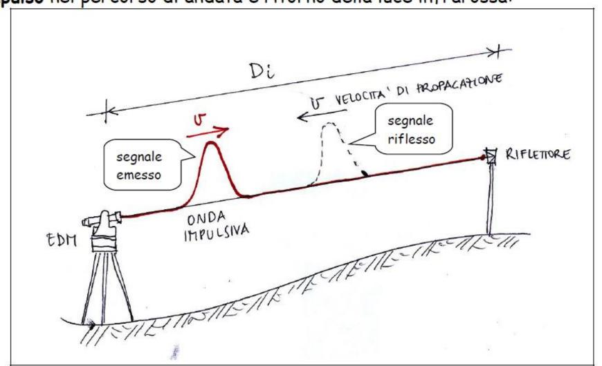
Il distanziometro emette un **impulso** (segnale di brevissima durata ed alta intensità, paragonabile visivamente al lampo di un flash fotografico) di luce infrarossa laser (fascio di luce molto sottile e concentrato).
