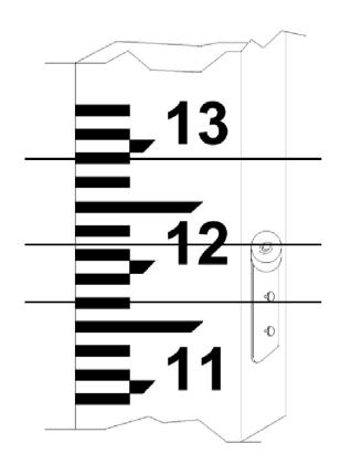
L'angolo parallattico costante si ottiene per mezzo dei fili distanziometrici del reticolo del cannocchiale: i raggi luminosi che passano per tali fili formano l'angolo  $\omega$ , la cui bisettrice è l'asse di collimazione (filo medio).
