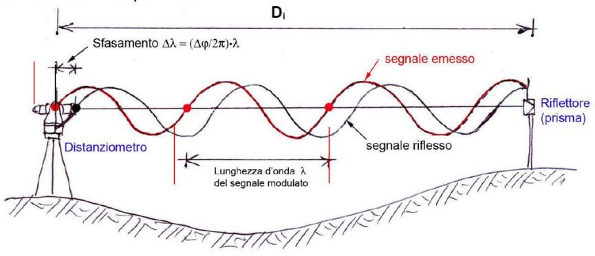
Il distanziometro emette un fascio di luce infrarossa modulata in ampiezza\* con legge sinusoidale. Il fascio di luce colpisce un riflettore (prisma o gruppo di prismi) che lo rinvia indietro deviandolo di 180°. La luce compie quindi un percorso di andata e ritorno (sistema definito Two-Way Ranging System). Il distanziometro comprende sia un trasmettitore sia un ricevitore, mentre il riflettore si limita a rinviare indietro la luce (riflettore passivo).
