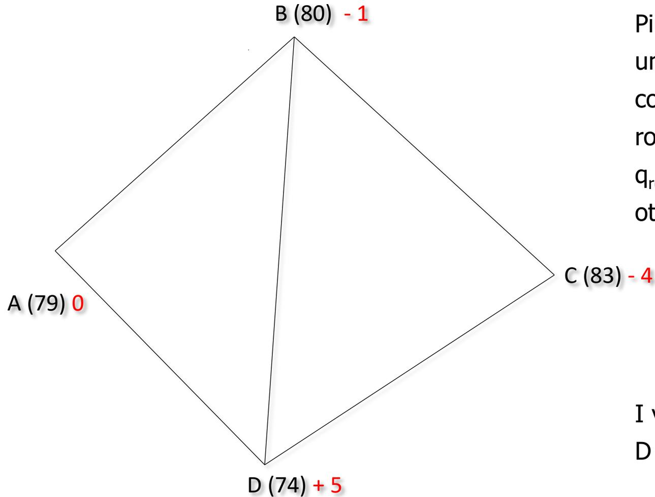
Più complessa è la situazione in cui il piano di progetto ha una **quota intermedia**. Per ora ipotizziamo che coincida con la quota del vertice A:  $Q_{P(A)} = Q_{T(A)} = 79$  m. La quota rossa del vertice A per quanto detto precedentemente è  $q_{r(A)} = 0$  m. Se calcoliamo le quote degli altri vertici otteniamo:
