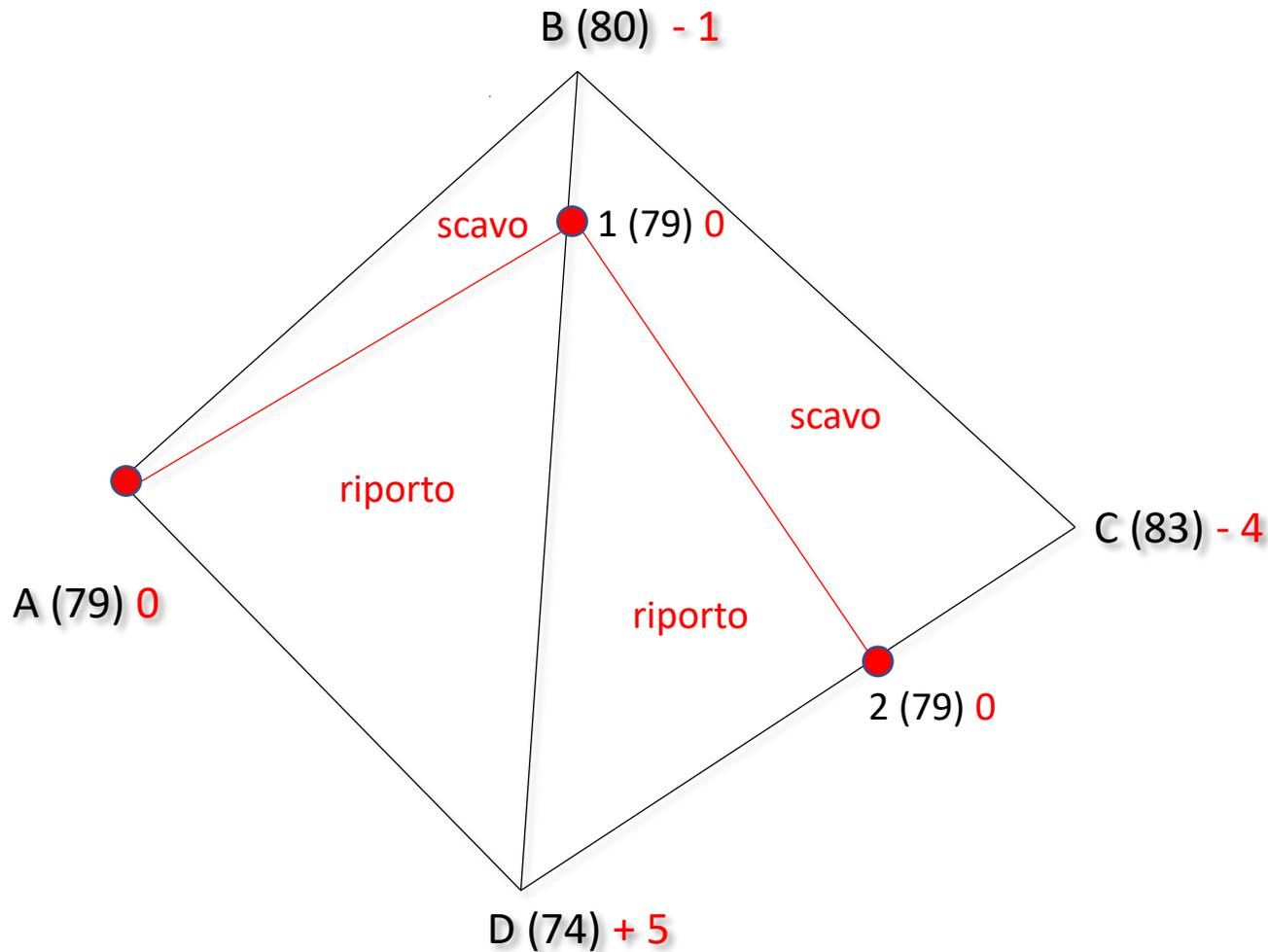
La **posizione dei punti di passaggio** sui lati può essere determinata utilizzando la **pendenza** del lato in esame
