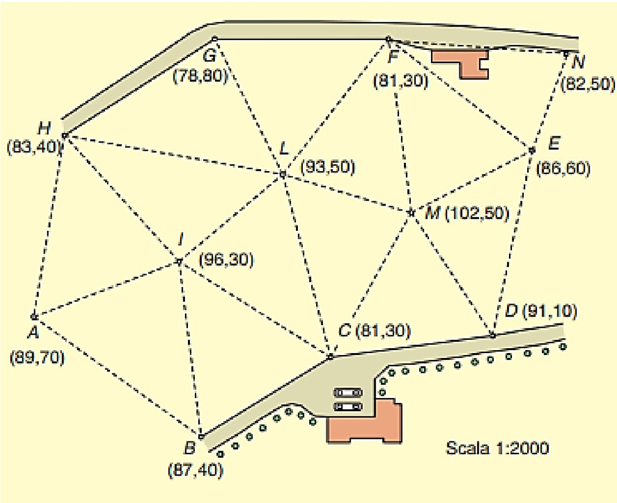
Si definisce piano quotato una rappresentazione plano altimetrica del terreno costituita da una o più falde triangolari piane, di cui si conosce la posizione dei vertici (coordinate X, Y, Q). La rappresentazione è corretta se i triangoli si adattano il più possibile al terreno. I lati dei triangoli sono segmenti di pendenza costante
