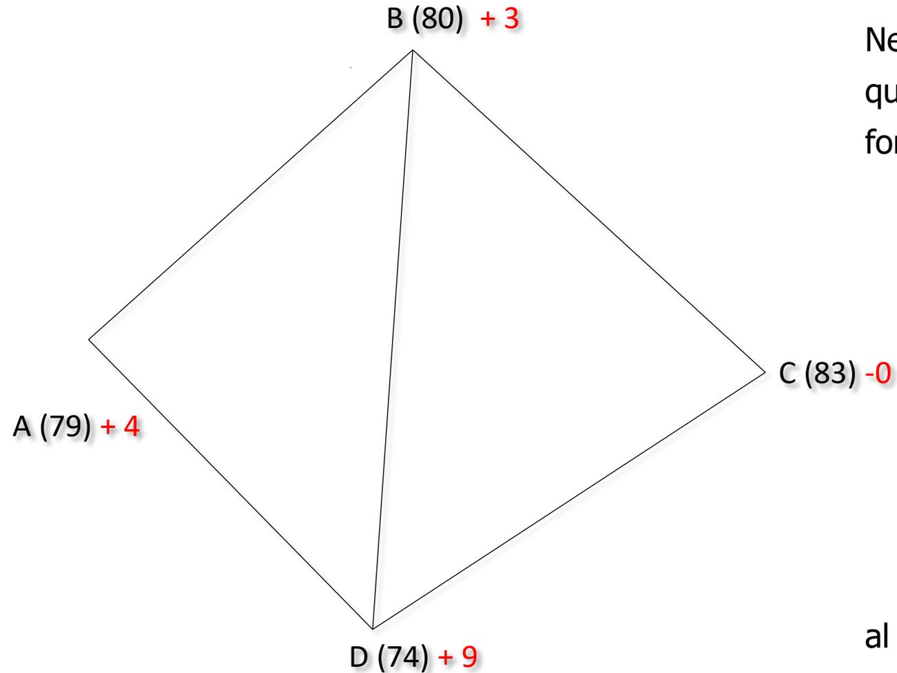
Nel caso in cui la quota del piano di progetto coincida con la quota del vertice più alto,  $Q_{P(C)} = Q_{T(C)} = 83 \text{ m}$ , con la stessa formula
