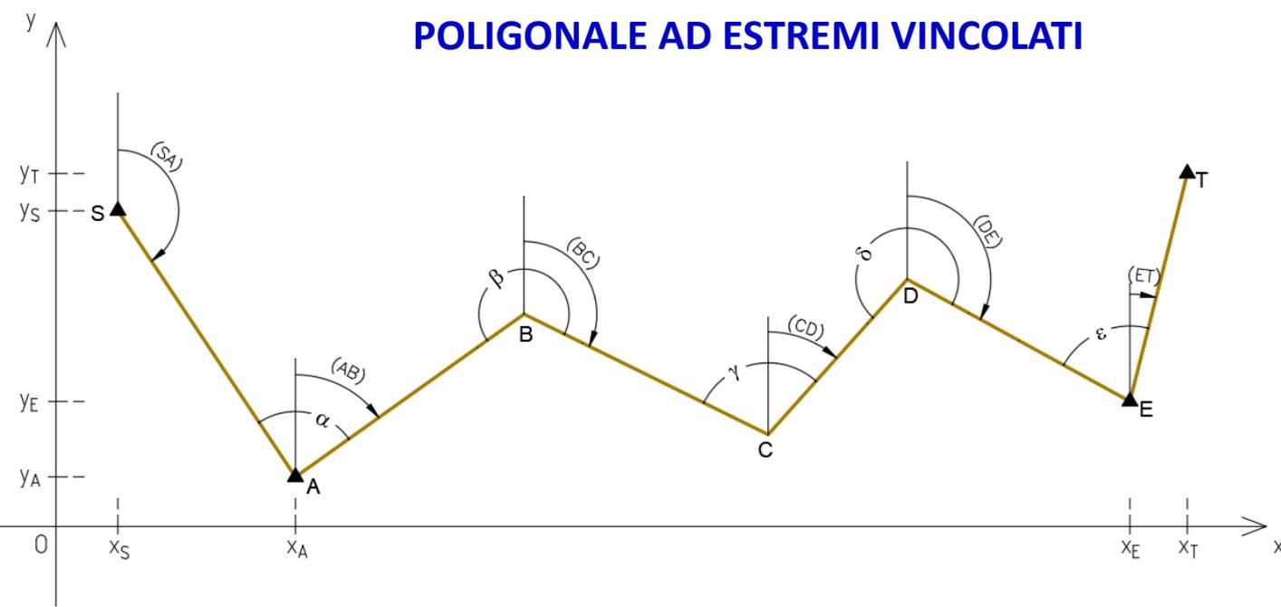
Dalla differenza tra l'azimut calcolato  $(ET)^\circ$  e quello esatto (ET), si ottiene l'errore totale angolare  $\Delta\alpha$
