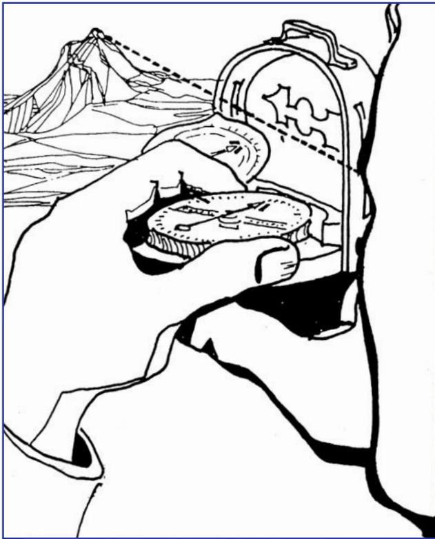
*Rilevamento di un azimut con bussola di tipo Bezard.*
